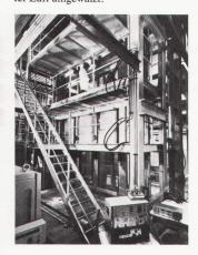
In Betrieb genommen wurde der Schüco-Fassadenprüfstand mit einer Prüfung eines zweigeschossigen Fassadenbauteils für ein Grossobjekt in Österreich. Der Auftrag umfasst 18 000 Quadratmeter dieser Fassade für das Verwaltungsgebäude eines bekannten österreichischen Stahlwerks.
