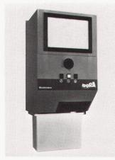
Der Wäschetrockner Bora arbeitet grundlegend anders als konventionelle Trockner, die mit Hilfe von warmer Luft die Nässe in der Wäsche austrocknen. Bora entzieht der Luft die Feuchtigkeit. Mit Hilfe eines Ventilators saugt er die feuchte Raumluft an und kühlt sie im Apparat darin bis gegen den Taupunkt ab. Im Bereich um 0 °C kann die Luft das Wasser nicht mehr halten und scheidet es aus. Es bleibt im Gerät und tropft in einen Auffangbehälter. Die trockene Luft geht in den Raum zu-
