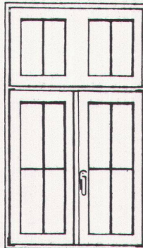
2flügeliges Fenster mit Oberlicht und Sprossen
