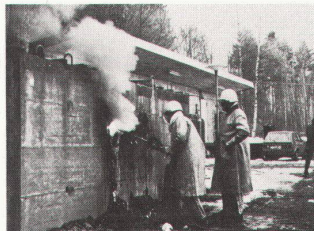
Die neuentwickelten Panzelemente der Bauer Kassenfabrik AG sind eingehenden Prüfungen unterworfen. Das Bild zeigt den Test mit der Sauerstofflanze, einem der gefürchtetsten Angriffswerkzeuge.
