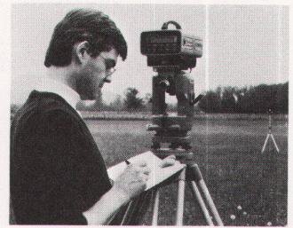
Citation Das neueste elektronische Vermessungsinstrument im Wild-Programm: der reduzierende Infrarot-Distanzmesser Citation CI-450. Bemerkenswert ist das grosse Bedienungs-/Ablese-Panel. Der CI-450 ist hier auf den Skalentheodolit Wild T16 aufgesetzt.
