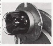
Schnittbild eines Kleinstflammkopfes mit deutlich sichtbarer Minidüse. Im aufgeschnittenen Flammrohr erkennbar die Austrittsöffnungen für die vorgewärmte Verbrennungsluft. Sie erlaubt eine vollständige Verbrennung und hohe Wirtschaftlichkeit.
