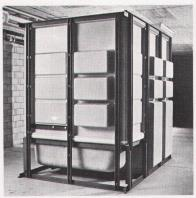
Eine praktische Bauweise und Zugänglichkeit der Installationsteile sind der Vorteil dieses Systems, das sich vor allem für Neuund Umbauten eignet. Die im Rohbau vorgesehenen Sanitärräume werden durch vorgefertigte Elemente ausgekleidet. Fertig-elemente aus Acrylglas und Verbindungsteile aus Stahl und Aluminium, mit denen Masstoleranzen aufgenommen werden, ermöglichen eine individuelle Ausstattung und eine differenzierte Farbgebung des Rau-
