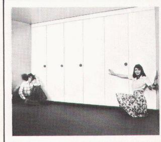
**10 Normbreiten.** Durch das Mischen der Normbreiten entstehen Zwischenräume, die einen Ausbau bis 5 cm der verfügbaren Breite erlauben. Hm-Normschrank E einschlagend, mit dem bewährten Klavierband. Neu: Hm-Siro-Normschrank mit dem neuen 3fach verstellbaren Sichtrollscharnier.
