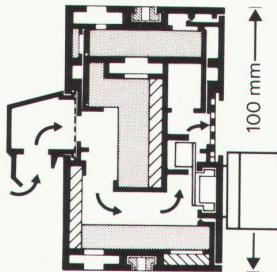
Fenster-Zuluftelemente Typ ZE 100 sorgen für Frischluft und schützen vor Lärm. Sie fügen sich in jeden Blendrahmen und Glasfalz und sind darum – bei Sanierungen etwa – die ideale Lösung.
