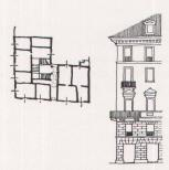
9. Bürgerliches, neu gebautes Haus Diese Zelle befindet sich im ganzen Stadtgebiet, besonders in den Zonen des XIX. Jh. Wegen des regelmässigen Baus kann sie vorwiegend für öffentliche Räume verwendet werden. Die senkrechten Verbindungen sind streng in den Eckzonen geplant. Dachfenster, Fassade typisch XIX. Jh., Türen, Fenster und Balkone mit Gusseisengeländer kennzeichnen die Architektur.
