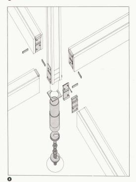
Isometrische Darstellung des konstruktiven Systems / Représentation isométrique du système de construction / Isometric representation of the structural system
