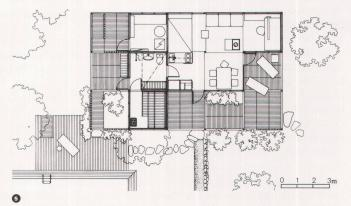
Grundrissvarianten, auf dem Rastermass von 225 cm aufgebaut / Variantes du plan établies sur un quadrillage de 225 cm / Plan variants, built up on the grid of 225 cm
