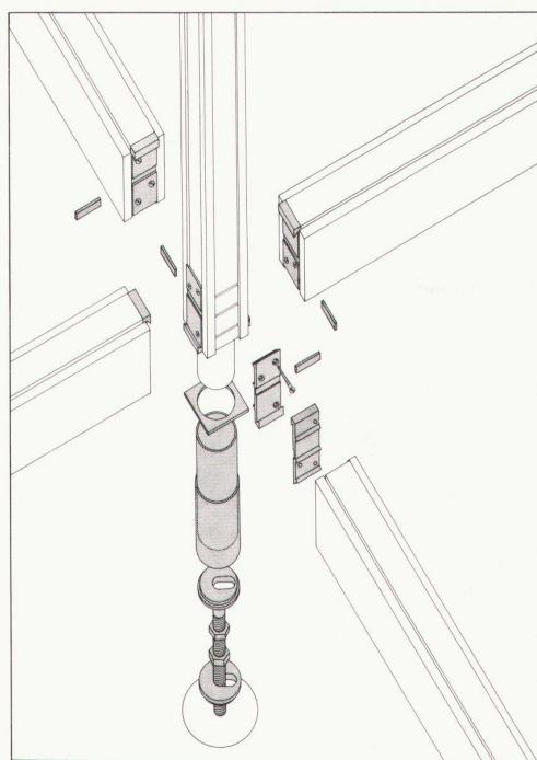
1 Isometrische Darstellung des konstruktiven Systems / Représentation isométrique du système de construction / Isometric representation of the structural system
