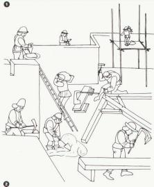
Wie sparte nun die Antike Holz? Sie baute Teilgerüste, die je nach Baufortgang umgestellt wurden. Grossflächige Rüstungen wurden vermieden. Wegen des Holzmangels in Attika schliesst der amerikanische Archäologe Carpenter die völlige Einrüstung der griechischen Tempel aus; er nimmt an, dass die Säulen einzeln eingerüstet wurden, das Gerüst dann von Säule zu Säule verschoben wurde.
