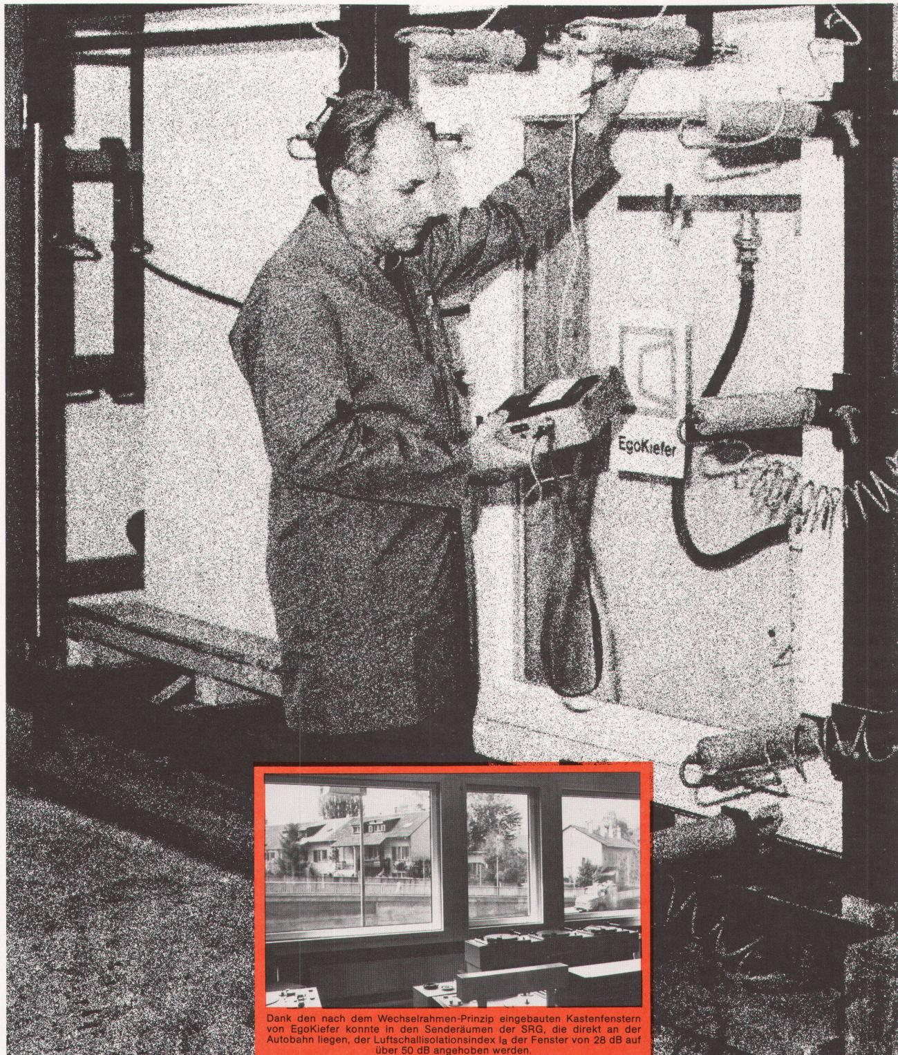
Dank den nach dem Wechselrahmen-Prinzip eingebauten Kastenfenstern von EgoKiefer konnte in den Senderäumen der SRG, die direkt an der Autobahn liegen, der Luftschallisolationsindex  $\Delta$  der Fenster von 28 dB auf über 50 dB angehoben werden.
