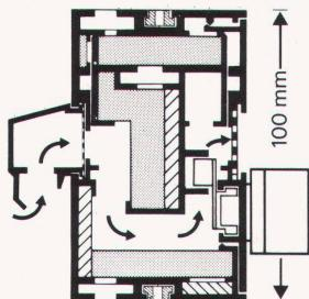
Fenster-Zuluftelemente Typ ZE 100 sorgen für Frischluft und schützen vor Lärm. Sie fügen sich in jeden Blendrahmen und Glasfalg und sind darum – bei Sanierungen etwa – die ideale Lösung.
