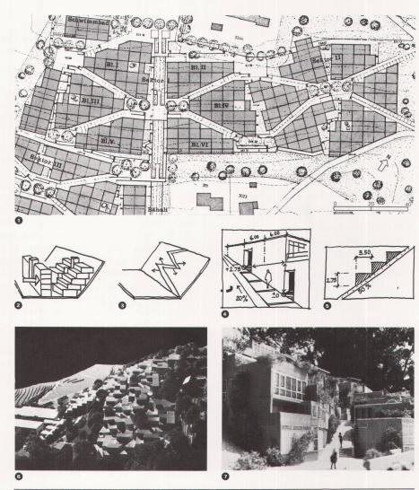
Regelmässiger Raster, Diagonalwege mit Plätzen in den Kreuzungspunkten. Diese Plätze werden in der Fallinie durch «Abkürzungen» verbunden. Die Zäsuren erlauben es gleichzeitig, die Bebauung dem Kurvenverlauf anzupassen. Ausserdem kann durch eine solche Zäsur eine «Bergbahn» geführt werden, die vom Zentrum im flachen Gelän de aus das ganze Quartier erschliesst.
