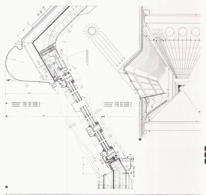
Schnitt durch Fassade und Gang der Zentrale/Coupe sur la façade et le couloir de la centrale/Section of elevation and passageway of the central
