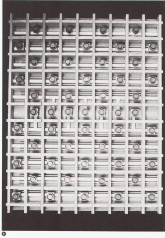
Detailmodell: Zugstütze – Druckstütze – Durchscheinende, isolierte Wandelemente 1800×900 mm / Modèle de détails: Support de traction – Support de compression – Elément de paroi translucide et isolé de 1800×900 mm / Element model showing: Tension column – Compression column – Translucent insulated fixed wall 1800×900 mm
