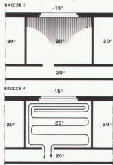
Die Fussbodenheizung wäre am wirtschaftlichsten, wenn sie sämtliche Wärme über den Boden nach oben abgeben könnte. Tatsächlich werden ca. drei Viertel der Wärme nach oben, ca. ein Viertel davon wird aber nach unten abgegeben. Da der physiologisch optimale Wärmeverlauf aber einen kontinuierlichen
