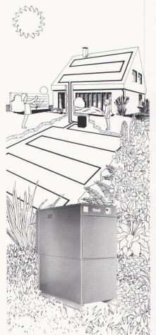
Dieses Beispiel zeigt, wie in der Erde gespeicherte Sonnenenergie genutzt werden kann. Die unsichtbaren Rohrkollektoren unter dem Dach sammeln die Sonnenwärme, der Erdkollektor lagert sie und die Hoval-Wärmepumpe bringt sie auf die für die Heizung oder die Warmwasserbereitung erforderliche Temperatur. Dieses bewährte System zeichnet sich durch einen besonders geringen Verbrauch an Primärenergie aus.
