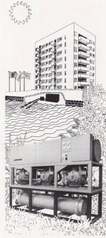
See-, Fluss- und Grundwasser speichern riesige Mengen von Sonnenenergie. Mit Hilfe von Hoval-Wärmepumpen kann diese für grosse und kleine Anlagen auf vorteilhafte Weise genutzt werden. Auch technische Wärmequellen wie Abwasser, Abluft oder industrielle Abwärme bilden günstige Voraussetzungen für Hoval-Wärmepumpensysteme.
