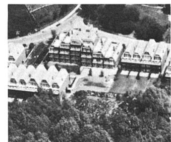
1 maison locative et 31 maisons individuelles en bandes, dont 23 du type 4 avec au max. 5½ pièces, surface de base 4,80 × 14,70 m, surface habitable utile env. 165 m<sup>2</sup>, et 8 du type 6 avec au max. 7 pièces, surface de base 6,00 × 14,70 m, surface habitable utile env. 205 m<sup>2</sup>.
