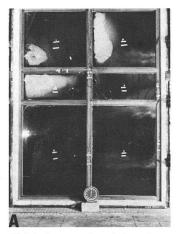
Bild A: Pyrostop-Brandschutzglas im Prüfstand. Nach 2 Minuten Befeuerung beginnen sich die ersten Aufschäumungen anzuzeichnen. Von blossem Auge jedoch ist im Normalzustand kaum ein Unterschied zu einem normalen Sicherheitsglas zu erkennen.
