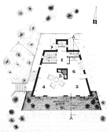
35 Grundriss Erdgeschoss/plan rez-de-chaussée. 1. Thermische Pufferzonen Nord/zones de tampon nord; 2. Thermische Pufferzonen Süd/zones de tampon sud; 3. Zentralkamine/cheminées centrales; 4. Wohnraum/séjour; 5. Essraum/manger; 6. Küche/cuisine.
