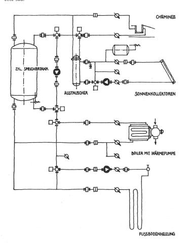
2 Schema einer Heizungsanlage/schéma d'un dispositif de chauffage.
