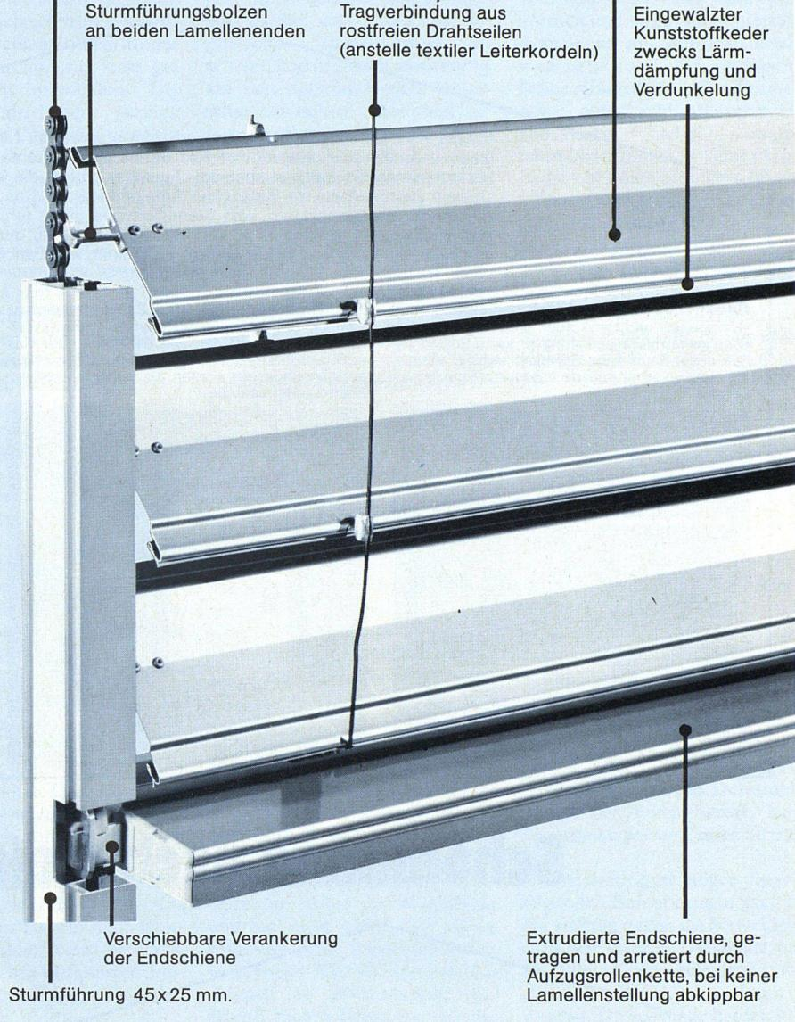
Extrudierte Endschiene, getragen und arretiert durch Aufzugsrollenkette, bei keiner Lamellenstellung abkippsbar
