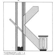
Die Wärmedämmscheibe von Thermoplus hält die Heizwärme im Raum
