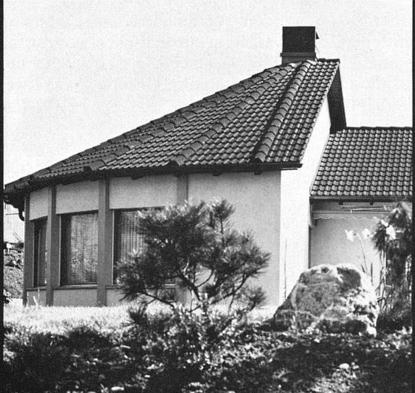
Der Braas-Redland Pfannenziegel wird mit glatter oder besandter Oberfläche hergestellt. Der besandte Ziegel eignet sich besonders für Höhenlagen über 800 m, da er wirksam das Abgleiten von Schnee verhindert.
