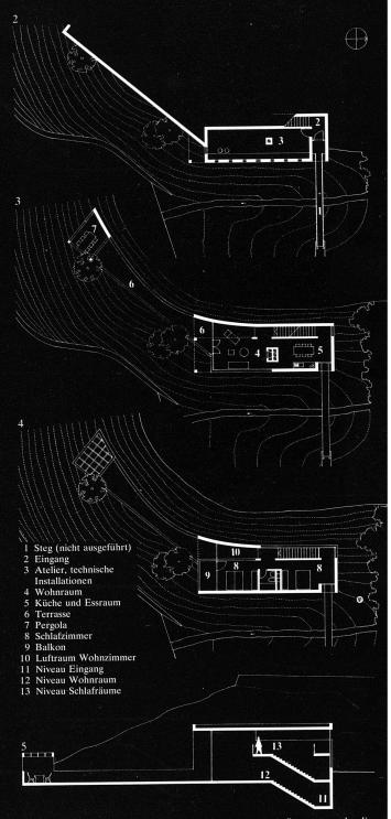
2 Grundriss Eingangsgeschoss. Der geplante Zugang mit Steg vom nebenliegenden Terrain kam nicht zur Ausführung. Zum Eingang gelangt man nun über einen zum Haus parallelen, abgetreppten Weg, welcher an der tiefer liegenden Strasse beginnt
