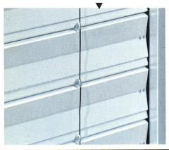
Aufzugsrollenkette (anstelle Aufzugsband) bewirkt zwangsläufigen Antrieb und Prägnantes Lamellenprofil (ohne Schlitze) automatischen Verschluss in unterster Stellung. für Aufzugsbänder) Tragverbindung aus rostfreien Drahtseilen Sturmführungsbolzen Eingewalzter Kunststoffkeder an beiden Lamellenenden (anstelle textiler Leiterkordeln) zwecks Lärmdämpfung und Verdunkelung Extrudierte Endschiene, ge-Verschiebbare Verankerung tragen und arretiert durch der Endschiene Aufzugsrollenkette, bei keiner
