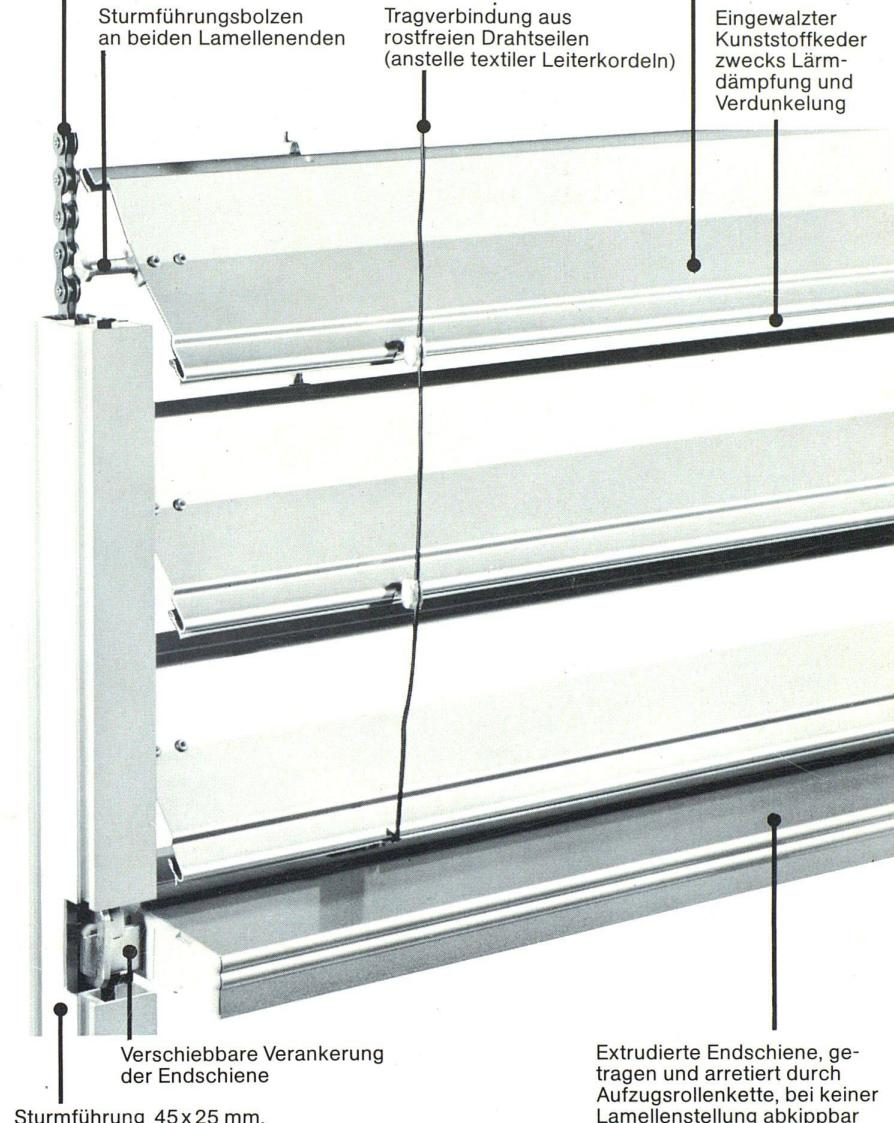
Extrudierte Endschiene, getragen und arretiert durch Aufzugsrollenkette, bei keiner Lamellenstellung abkippbar
