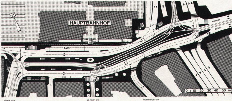
Der Bau einer Fußgängerunterführung unter dem Bahnhofplatz von Zürich ergab die Möglichkeit, an dieser günstigen Verkehrslage ein eigentliches unterirdisches Ladenzentrum zu erstellen, das 27 verschiedene Geschäfte sowie ein Restaurant enthält
