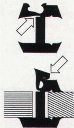
Ein im Profil eingebautes Gelenk ermöglicht ein spielend leichtes Umlappen der Dichtlippe.
