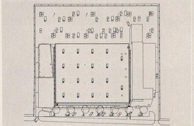
Für den Forschungs- und Bürobau der Computer Technology Ltd in Hemel Hempstead haben die Architekten, ähnlich wie bei der vorangegangenen Publikation (S. 332–334) ein flexibles Stahlbausystem angewendet. Sperrholzplatten, beidseitig mit Aluminium verkleidet, bilden den oberen Teil der Fassaden. Isolierung der Fugen mit Neopren-Profilen
