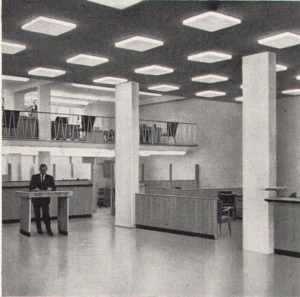
Größen der Deckenplatten. Die flache Konstruktion gewährleistet die Montage auch bei geringer Einbautiefe. Unterschiedliche Abdeckwannen und Formen, die sich auch zu Lichtbändern und Feldern zusammensetzen lassen, ermöglichen eine variable Gestaltung. Zur Erleichterung der Montage werden Befestigungsteile
