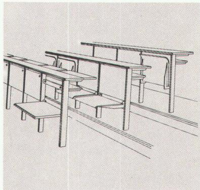
Die ansteigende Stufenbestuhlung ermöglicht allen Schülern freien Blick auf den Experimentiertisch oder eine bessere Sicht in Film- oder Lichtbild-Vorführungen. Moderne hartvernickelte Rechtecksäulen, unter dem Boden befestigt, tragen farbfreudige Schreib- oder Experimentierplatten aus Holz, Kunstharz oder Pressholz. Breite Sitzflächen der Stuhlsitze klappen durch in Nylon-Büchsen geräuschlos gelagerte Federn automatisch hoch.
