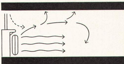
1. Die Fensterkälte, die sinken möchte, wird von der Radiatorenwärme, die steigen möchte, aufgefangen. Der entstehende Wärmestrom verteilt sich gleichmässig im Raum.
