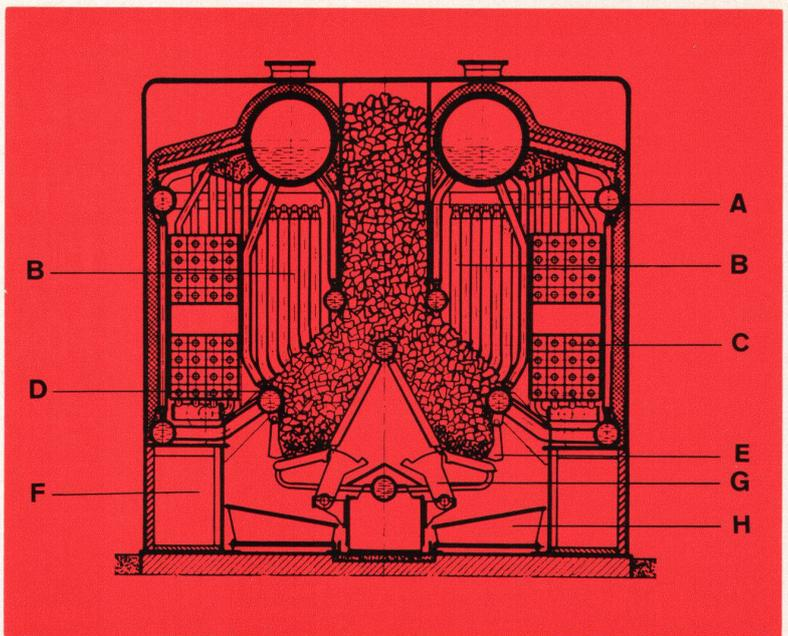
Der Omega-Kessel ist ein Strahlungs-Wasserrohrkessel mit Leistungen von 0,6 bis 2,5 Mio kcal/h. Aus seiner Bauart als Füllschachtkessel mit unterem Abbrand ist ersichtlich, daß es sich um einen Spezialkessel für Koksfeuerung handelt.
