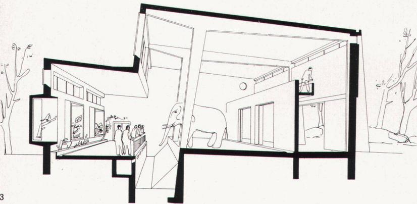
Die Beheizung des Raumes (im Winter minimum 18°, 35 % rel. Feuchtigkeit) übernimmt zur Hauptsache die Lüftungsanlage mit ergänzenden Radiatoren. Der große Warmwasserverbrauch wird durch einen Weco-Cipax Boiler 3500 l beschafft. Das Badebassin im Innern hat 12 m³ Inhalt und wird in 6 Stunden mit Wasser von 25° gefüllt. Die künstliche Raumbeleuchtung erfolgt indirekt durch die längs den Fenstern angeordneten Fluoreszenzröhren.
