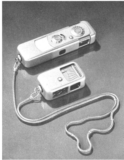
Minox-Kleinstbild-Kamera und Beleuchtungsmesser (Bildgröße 8x11 mm) | Petit appareil de photographie et pose-mètre | Small camera and light-meter
