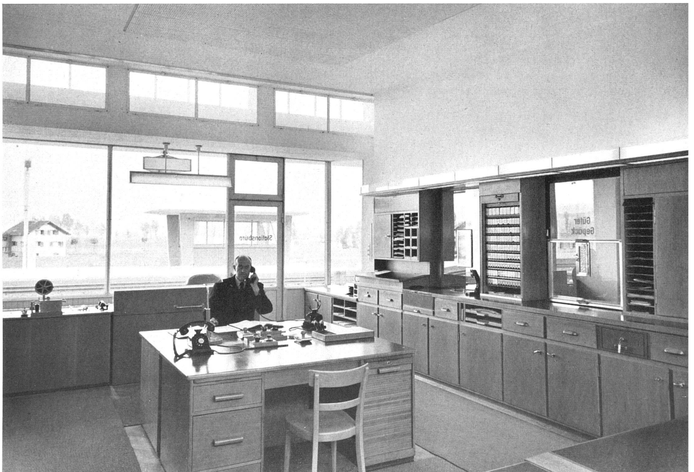
Blick vom Stationsbüro auf die Geleise. Das Oberlicht erhellt den Raum, auch wenn Wagen direkt vor dem Büro stehen | Le bureau de la gare avec vue sur les voies | View from station office to railway lines
