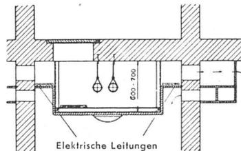
Lüftungskanal unter Flurdecke
