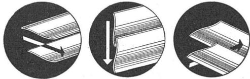
Die patentierten S-förmigen Lamellen der KIRSCH Sun Air-Stores gewähren ein idealeres Abschirmen der direkten, blendenden Sonnenbestrahlung, unter gleichzeitiger Schaffung günstiger Licht- und Temperaturverhältnisse.
