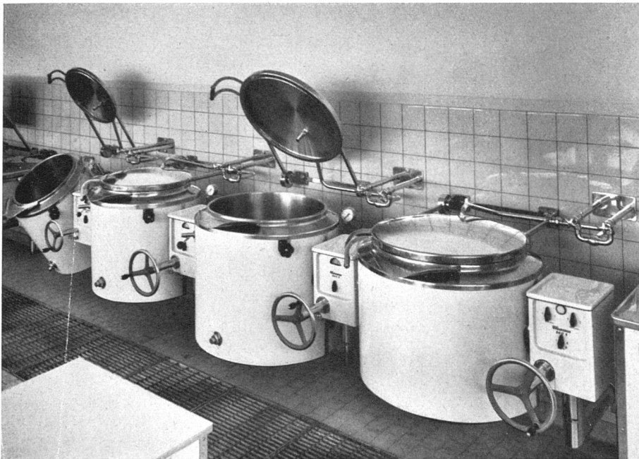
(von l. n. r.) Elektroden-Kippkes- sel, rechts Kippkessel mit Strah- lungsheizung | (de g. à dr.) Groupe de marmites pivotantes | (from l. to r.) Group of tilting pans
