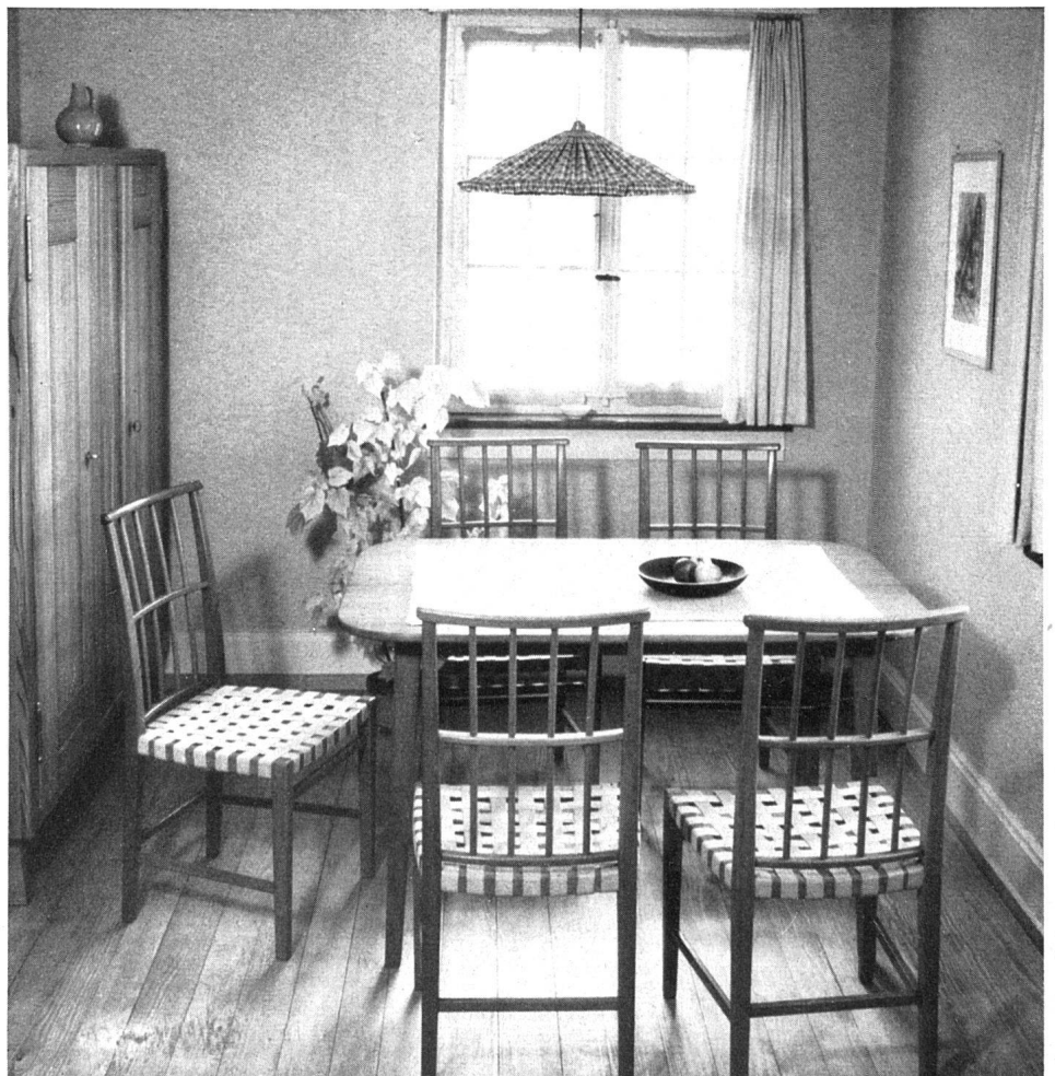
Eßplatz in verhältnismäßig engem Raum, daher sind Stühle und Tisch leicht und durchsichtig konstruiert. Links einfacher Schrank aus Lärchenholz. Stühle in gedämpftem Birnbaum mit Sitzen aus Hanfgurten Nauer & Vogel, Innenarch. VSI, Zürich
