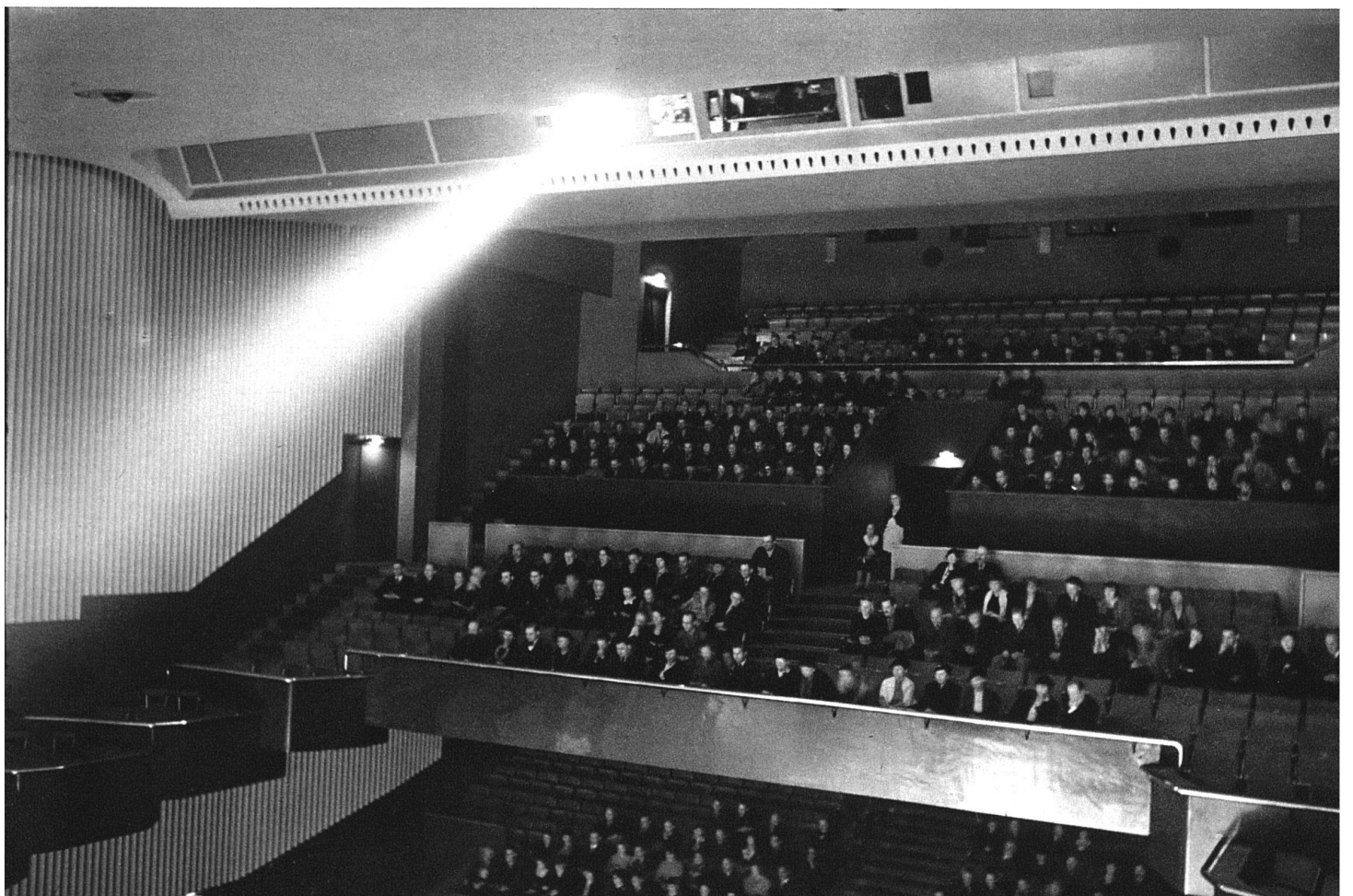
Corso-Theater, Zürich. Der umgebaute Zuschauerraum Aufnahmen S. 334, 335, 340: Foto Heinz Guggenbühl SWB, Zürich K. Knell, Architekt BSA, Zürich, und E. F. Burckhardt, Architekt BSA, Zürich Wände und Decke gelblichweiss, Wände mit konkaven Rillen. Stuhlpolster intensiv rot. Brüstungen der Balkone und Logen dunkelstahlblau, glänzend, mit 7 cm dicker Nickelstange. Wände und Decke der Galerie stumpfgraublau
