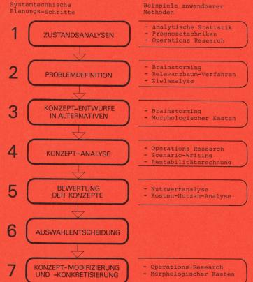
Abbildung 6: Planungsschritte und -methoden der Systemtechnik
