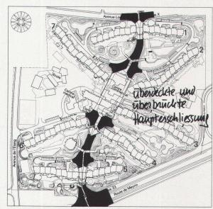
Überdeckte und überbrückte Haupterschliessung
