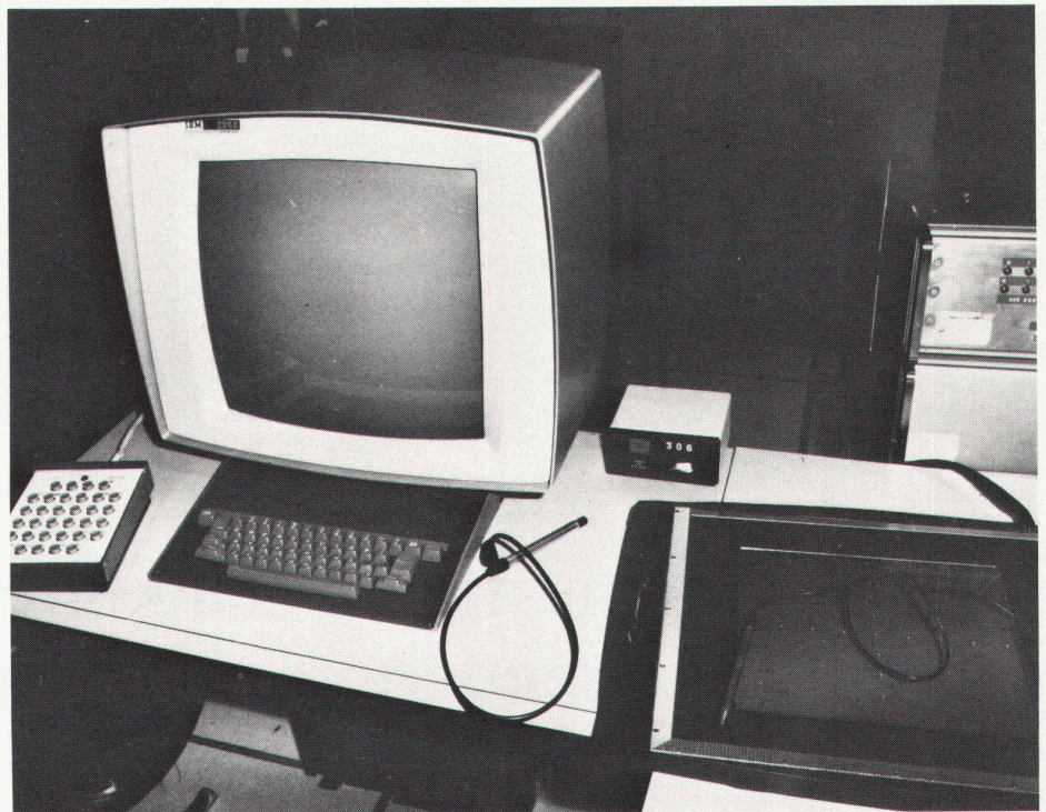
Figur 1: Der an einen Grosscomputer IBM 360/67 angeschlossene Terminal. In der Mitte der interaktive Bildschirm IBM 2250 mit Tastatur und Lichtstift, links die u. a. mit einem Zeichentisch verbundene Funktionstastatur, welche es ermöglicht, das Bild auf dem Bildschirm in «fester» Form zu erhalten. Rechts das Digitalisierungsgerät, das die Übertragung von einer Zeichenpause auf den Bildschirm gestattet.
