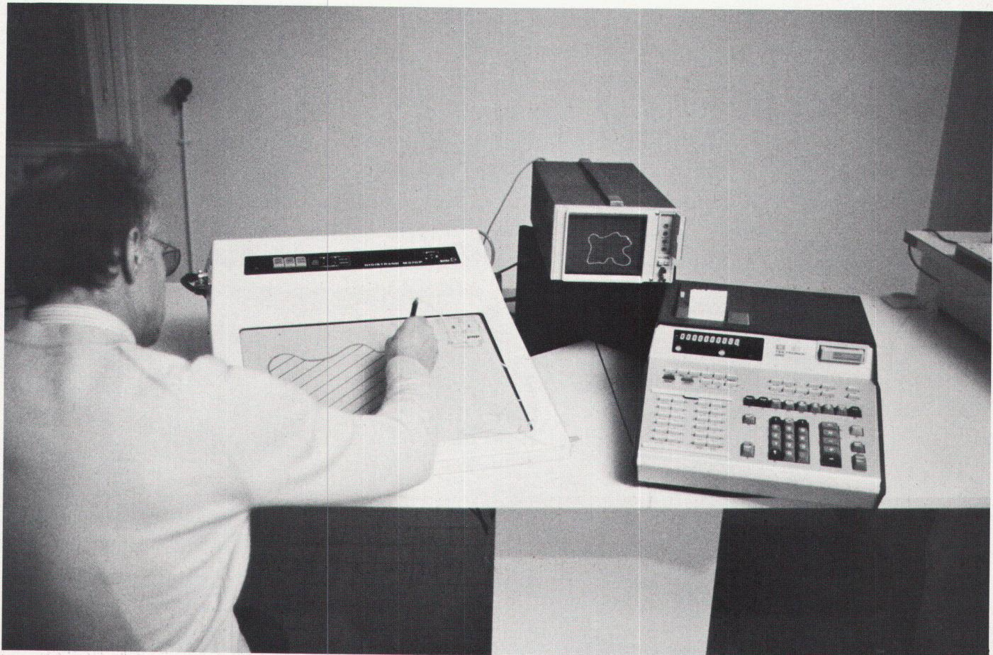
sont traduits graphiquement sur papier. Le traceur (*photo 14*, à droite) est piloté par une bande magnétique (à gauche) sur laquelle l'ordinateur à emmagasiné les ordres nécessaires à la restitution graphique des résultats obtenus sous forme de chiffres.
