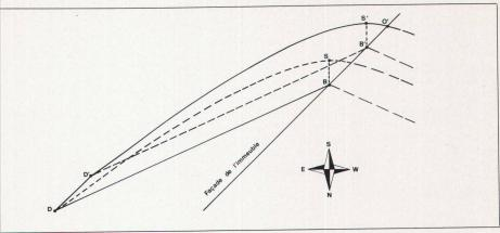
Fig. 7 Pare-soleil pour une fenêtre carrée de côté a exposée au sud-est (cas de la fig. 6).
