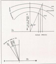
Fig. 2a Pourquoi le soleil ne se trouve pas toujours dans la même direction à la même heure (heure solaire vraie). Fig. 2b Les azimuts du soleil aux solstices et aux équino-
