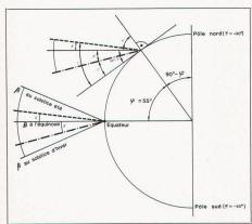
Fig. 1 Hauteur du soleil sur l'horizon.
