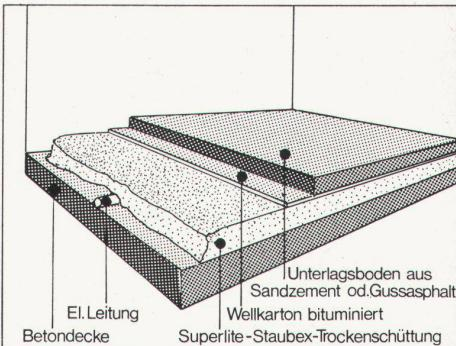
Querschnitt einer Fußboden-Unterkonstruktion mit Superlite.
