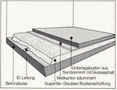
Querschnitt einer Fussboden-Unterkonstruktion mit Superlite
