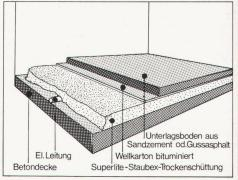
Querschnitt einer Fussboden-Unterkonstruktion mit Superlite
